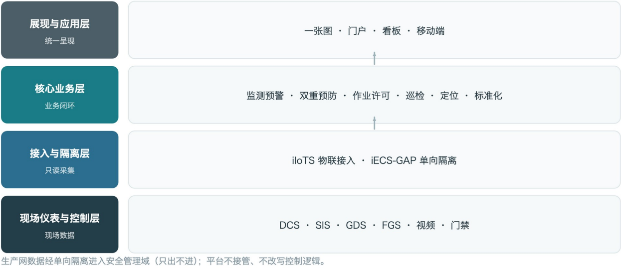
平台四层结构示意图。生产网数据经单向隔离进入安全管理域。
