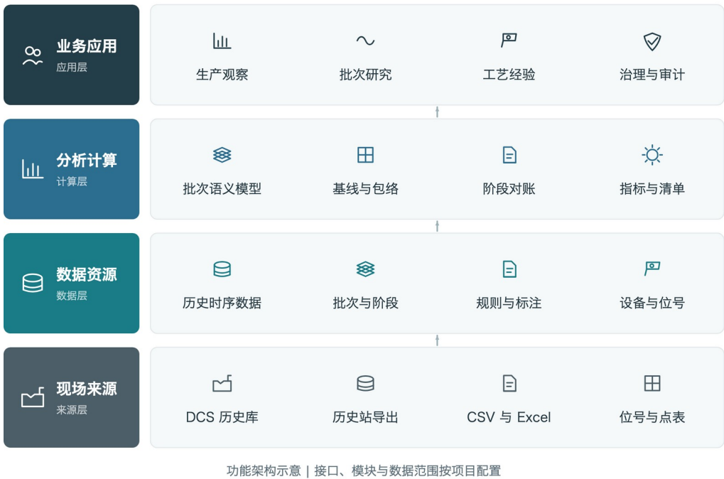
图 2 系统分层架构示意。数据经导入与质量处理后进入批次语义模型与分析应用。
