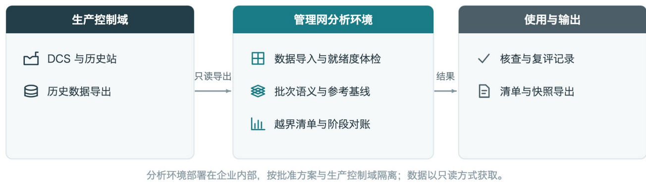
图 14 逻辑部署示意。分析环境按批准的网络方案与生产控制域隔离。
