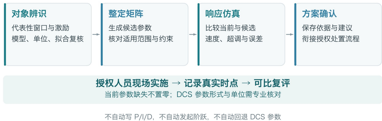
图 8 辨识—整定矩阵—仿真—方案确认。实施与复评由授权流程衔接，系统不自动改写 DCS 参数。
