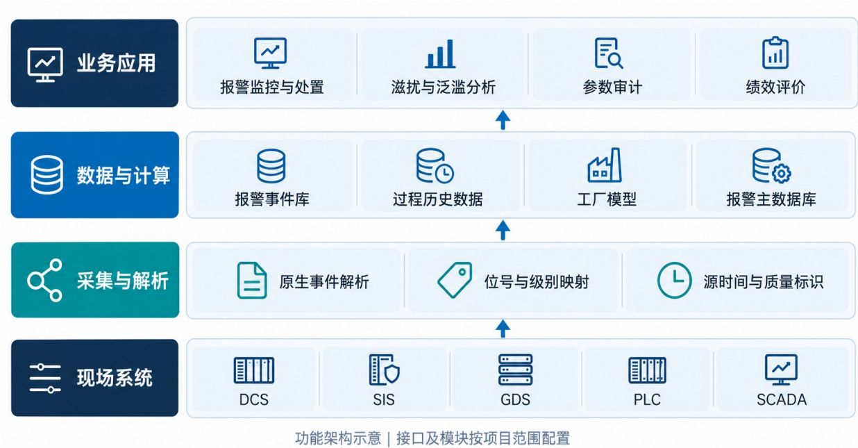
图 3 系统分层架构示意。现场数据经采集解析后进入报警管理应用。
